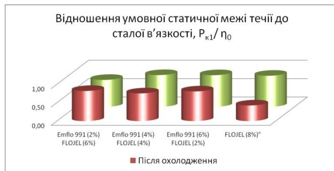
Рис. 4. Величина, характеризующая способность к пластическим деформациям ( P_{к1}/\eta_0 )
