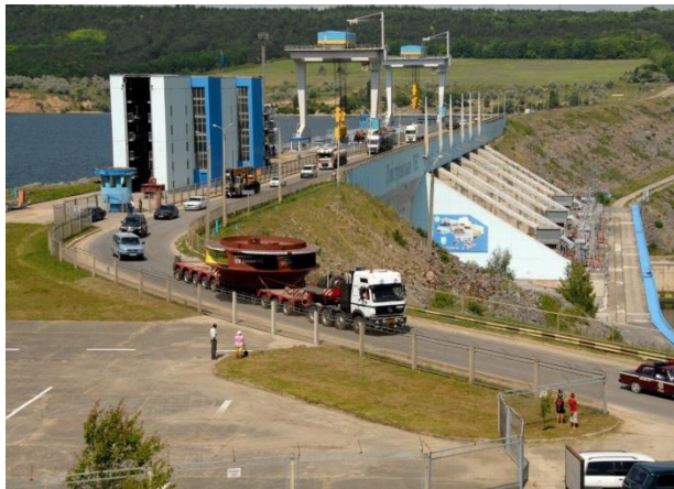
Рис. 7. Транспортування турбіни з залізничної станції до Дністровської ГАЕС
