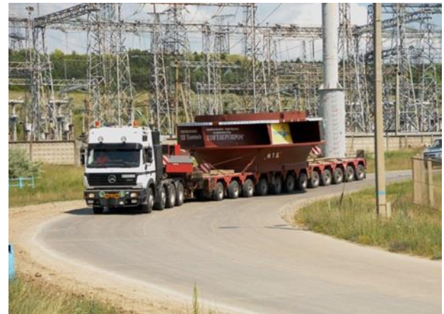
Рис. 7. Транспортування турбіни з залізничної станції до Дністровської ГАЕС
