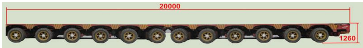
Рис. 6. Трейлерний потяг для перевезення негабаритних вантажів
