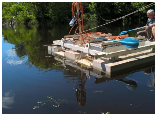
Рис. 1. Використання під час експериментальних досліджень електродинамічного імпульсного джерела сейсмічних сигналів ІДД-27 на воді
