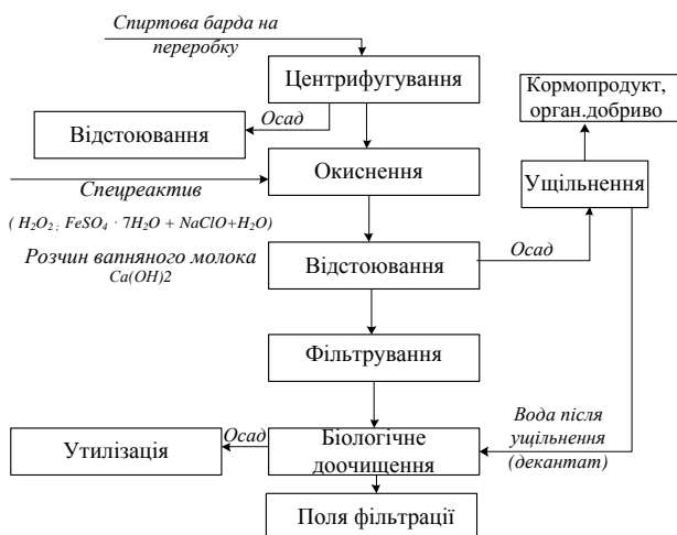
Рисунок 2. – Структурно-аналітична схема комплексної технології №2 переробки рідких відходів спиртового виробництва
