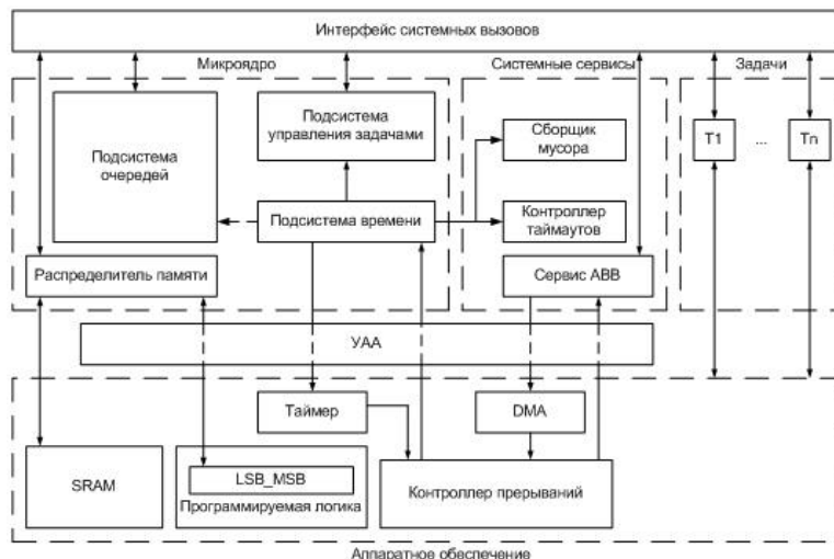
Рис. 2. Архитектура операционной системы Predicate OS
