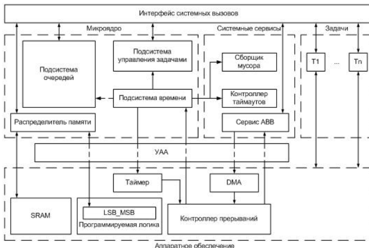
Рис. 2. Архитектура операционной системы Predicate OS
