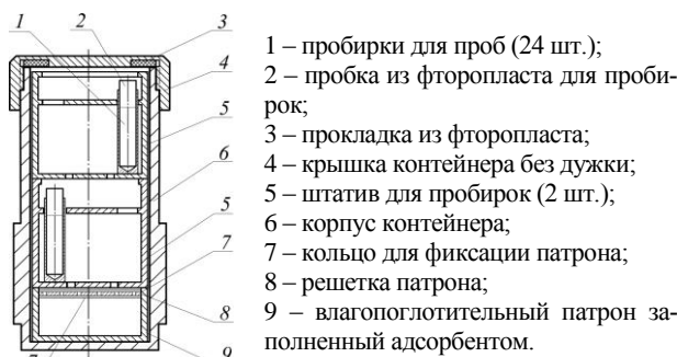
Рис. 4 – Металлический герметичный контейнер для хранения проб флюсов
