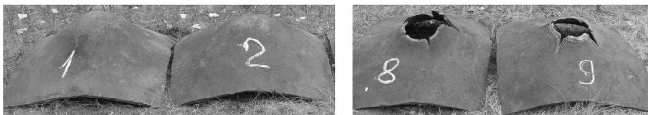
**Рис. 1.** Испытание ЭВВ на пластинах свидетелях (сталь 3, толщина 20 мм). Заряд d = 100 мм, полимерная оболочка; способ сенсбилизации: 1 – микросферы полимерные ПСВ-25; 2 – микросферы полимерные ПСВ-15; 8 – пероксидная газогенерация; 9 – стеклянные микросферы К1.
