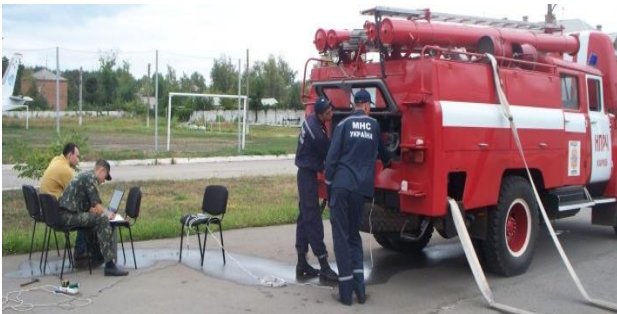
Рис. 1. Експериментальні дослідження вібрацій пожежного насосу на діючому аварійно-рятувальному автомобілі
