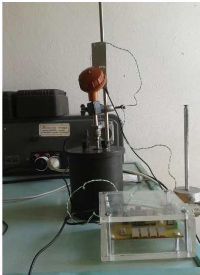
Рис. 8. Термопара ТХК1 і мікроконтролер з АЦП
