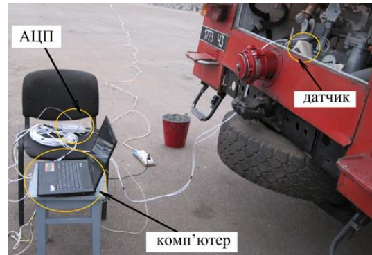
Рис. 2. Вимірювальний комплекс «Ультра-В-І» під час експериментальних досліджень
